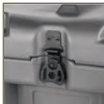
Запирающие механизмы с эксцентриком
